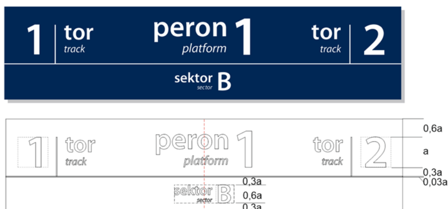
Rys. 35 Wzór tablicy zawierającej numerację peronu, torów i sektora oraz zasady ich tworzenia
