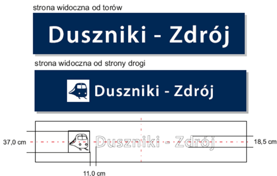
Rys. 25 Wzór tablicy dwustronnej zawierający z jednej strony nazwę stacji, oraz piktogram z nazwą stacji na drugiej stronie
