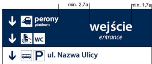
Rys. 50 Wzory tablic informujących o wejściu do obiektów infrastruktury kolejowej wraz z informacją o dojściu do infrastruktury przylegającej oraz zasady ich tworzenia
