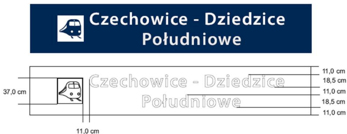
Rys. 28 Wzór tablicy zawierający nazwę stacji i piktogram oraz zasady jej tworzenia
