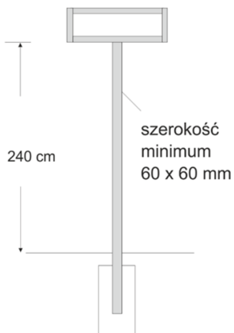
Rys. 95 Przykłady konstrukcji tablic
