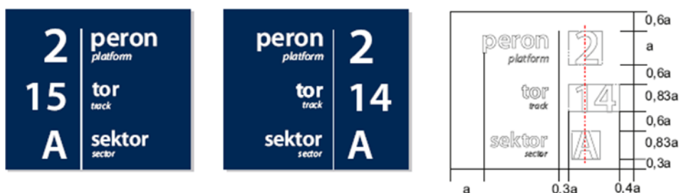
Rys. 38 Wzór tablicy zawierającej numerację peronu, torów i sektora oraz zasady ich tworzenia
