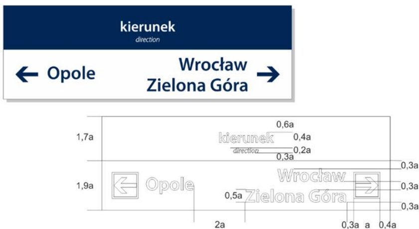
Rys. 47 Wzory tablic zawierających informację o kierunkach biegu pociągów oraz zasady ich tworzenia
