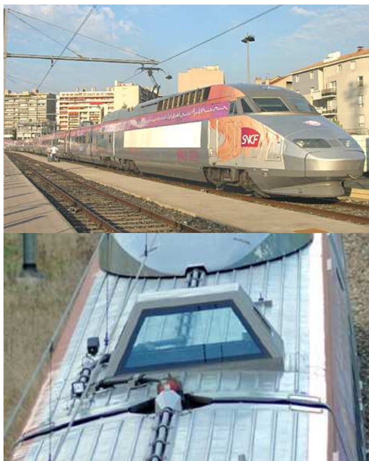
Rys. 10.3.1. Skład IRIS 320 – widok ogólny, stanowisko do obserwacji sieci jezdnej
