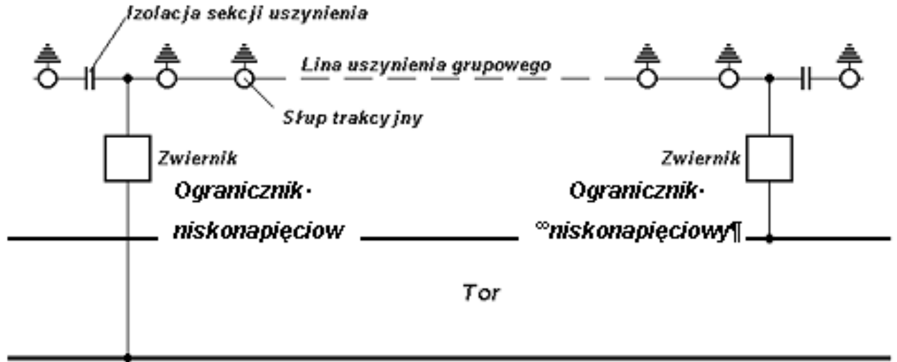
Rys. 1. Schemat ideowy systemu uszynienia grupowego w układzie otwartym.
