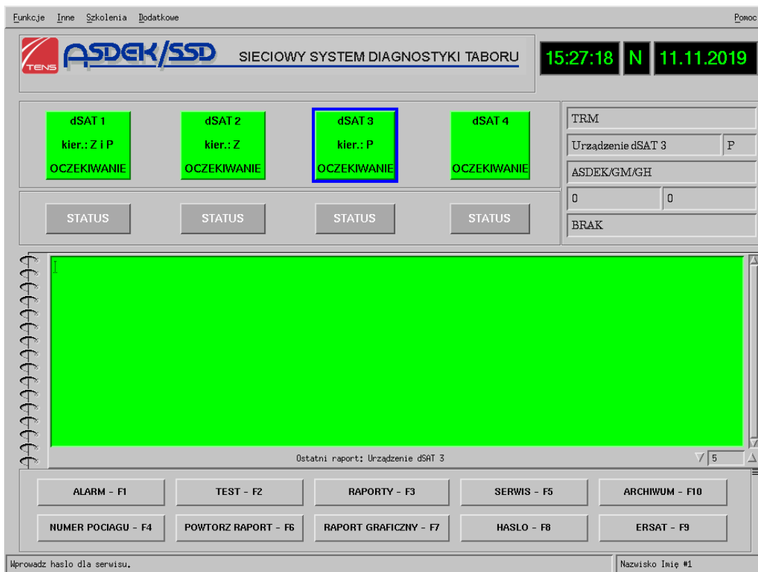
Rysunek 37 Wynik zmiany konfiguracji dla „Urządzenie dSAT 3” – po wznowieniu łączności z terminalem współpracującym
