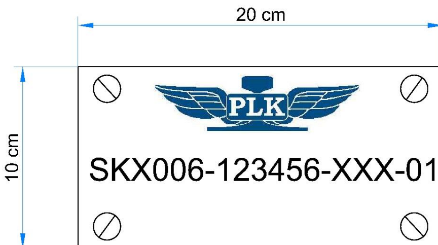
Rysunek 8 - Tabliczka znamionowa wewnętrznej pokrywy studni kablowej
