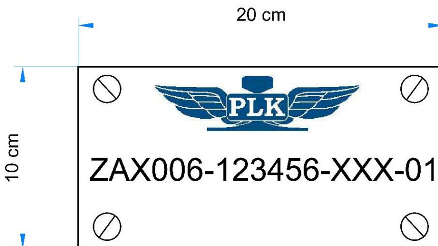
Rysunek 9 - Tabliczka znamionowa zasobnika kablowego
