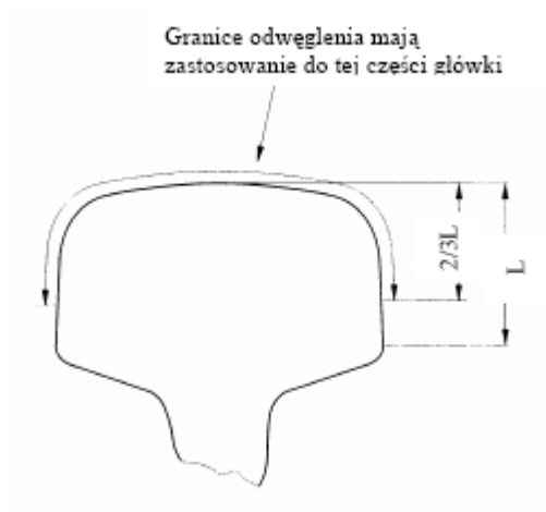
Rysunek 5. Obszar powierzchni główki podlegający kontroli odwęglenia
