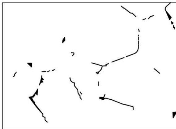
Rysunek 4. Fotografia mikrostruktury i dopuszczalna siatka ferrytu na granicach ziaren przy powiększeniu x500
