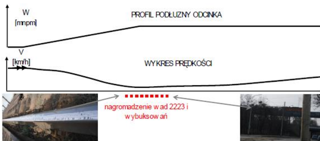
Rys. 3 Typowe rozmieszczenie wad 2223 i wybuxowań wynikające dużego pochylenia podłużnego toru (wzniesienie)
