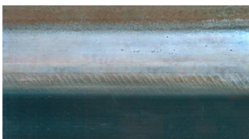
Rys. 6 Naprężenia kontaktowe na łuku - wada typu HEAD-CHECKING a) strefa krytyczna, b) przykład
