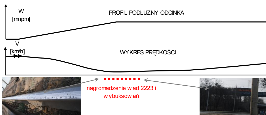
Rys. 3 Typowe rozmieszczenie wad 2223 i wybuxowań wynikające dużego pochylenia podłużnego toru (wzniesienie)
