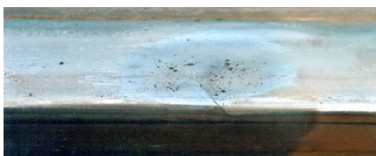
Rys. 7 Naprężenia kontaktowe na prostej - wada typu SQUAT: a) strefa krytyczna, b), c) przykłady
