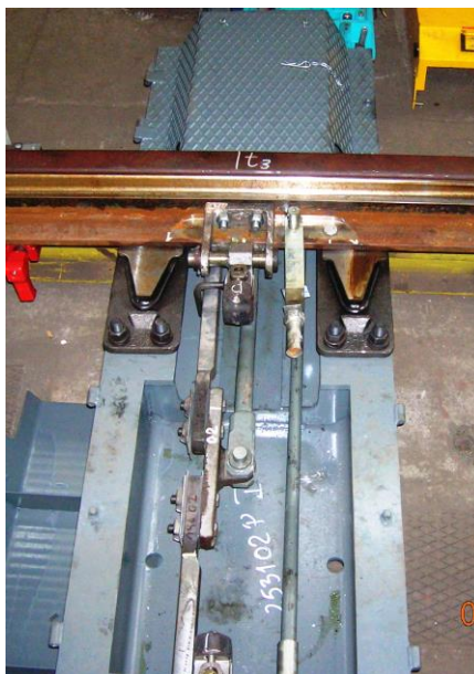
Rysunek 5 Przykład podrozdniczki zespolonej (pokrywa otwarta).
