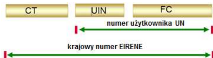
Rysunek 1. Struktura krajowego numeru EIRENE
