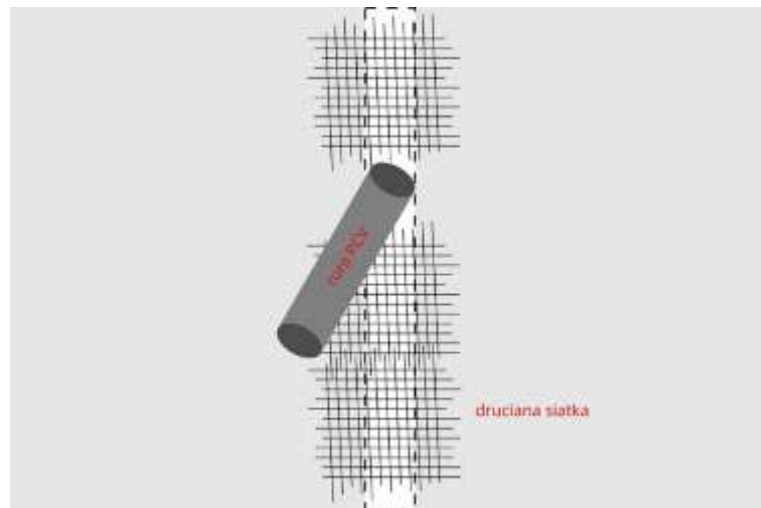
Ryc 63. Rozwiązanie zastosowane przez firmę Biotope (2015) podczas termomodernizacji budynków z wielorodzinnych w Poznaniu. Polega ono na szczelnym zatkaniu siedliska siatką o wymiarach oczek nie większych niż 1x1cm i pozostawieniu wylotu w postaci rurki PCV. Rurka powinna mieć średnicę wewnętrzną min. 36 mm i długość min. 20 cm. Powinna być skierowana w dół pionowo lub odstawać od pionu pod kątem do 45°. Rurka wewnątrz powinna być pozbawiona jakichkolwiek chropowatości. To rozwiązanie to ma zapewnić możliwość wylotu ze szczeliny i uniemożliwić powrót do schronienia.
